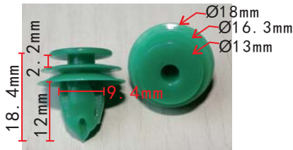
C1862 POM Green Door Panel Clip HONDA#91560-SZW-003
