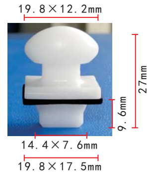
C340 POM White Front End Moulding Clip Ford W705849-S300 Mazda LC62-50-E11, E110-50-E13 Ford 2002-2000On
